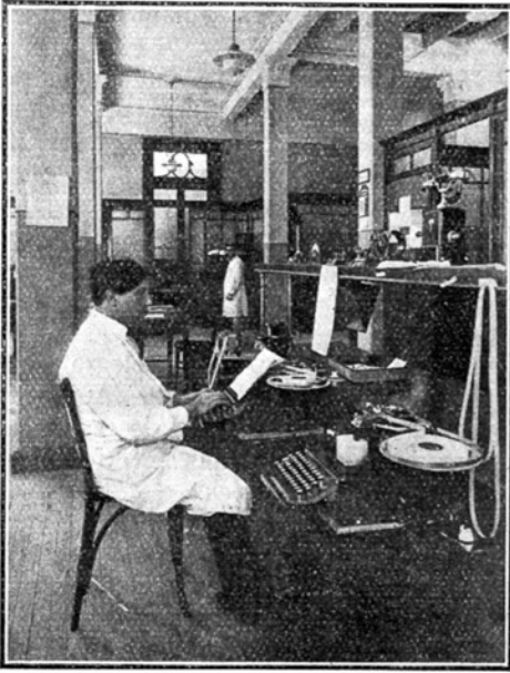
Preparación de los telegramas en cintas perforadas.
